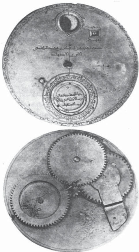
تصویر ۹- استفاده از چرخ دنده در اسطرلاب دوری، اصفهان ۶۱۸ هجری
