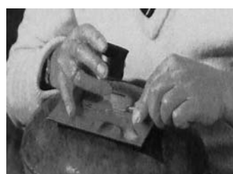
تصویر ۲۶-حکاک با دست بر روی پلیت فولاد
