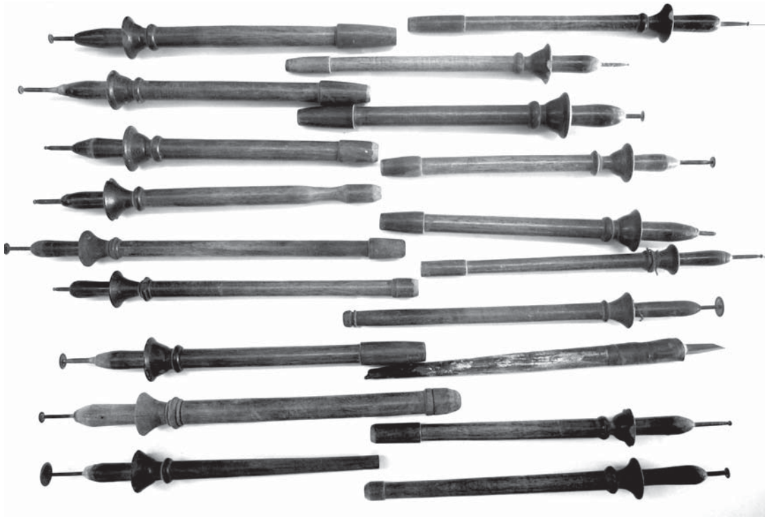
تصویر ۸- تنوع تیغه‌های دستگاه عقیق‌کن، این تیغه‌ها بسته به ضخامت قلم ترکیب، اندازه حروف، ظرفیت‌های شکلی حروف و درجه گودی مورد نظر، متنوع بوده است، قدمت قاجاریه و پهلوی، مجموعه خاندان حمیدی حکاک شیرازی، ماخذ: نگارندگان
